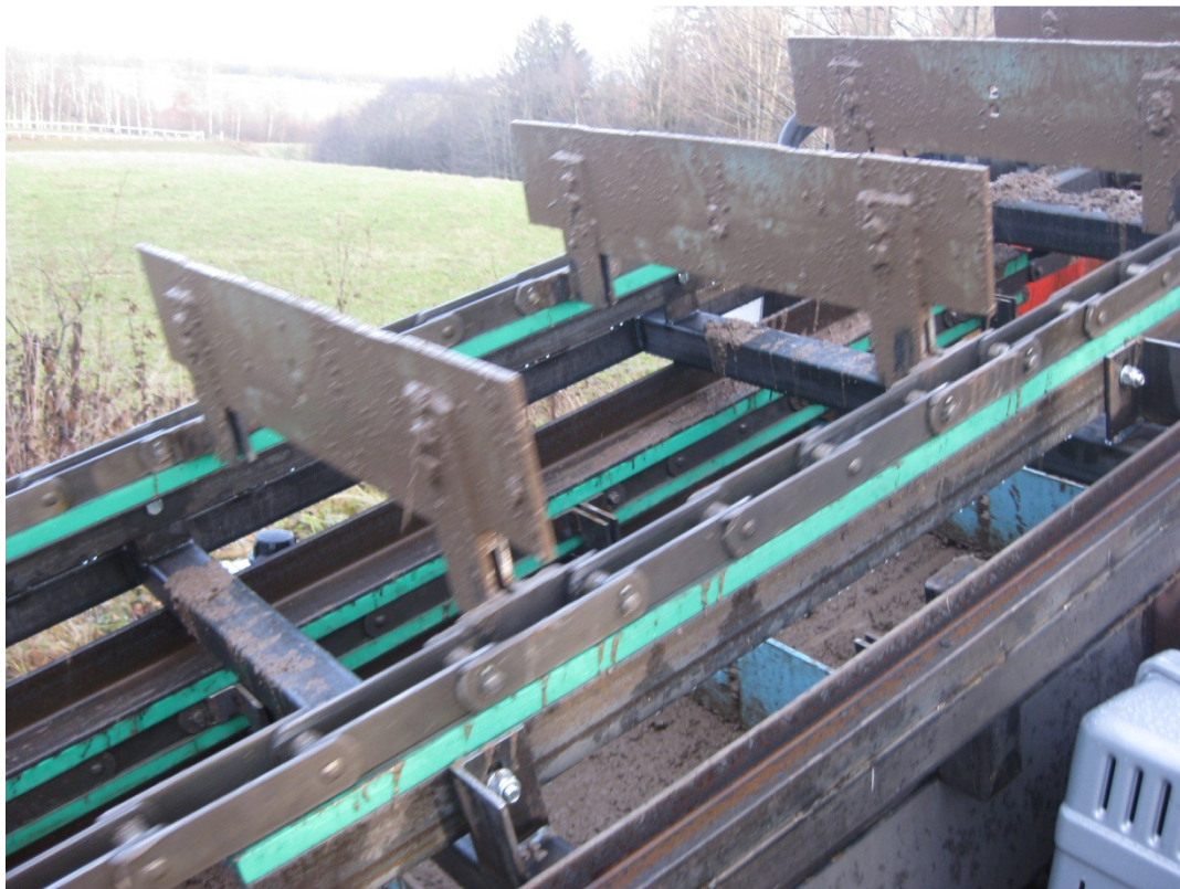
Detaljbild på de kedjedrivna skovlarna. C/c avståndet på dessa samt hastigheten på kedjan kan enkelt anpassas efter förhållandena på vägen. Skovlarna utgörs av standard plogstål och är enkla att byta.
