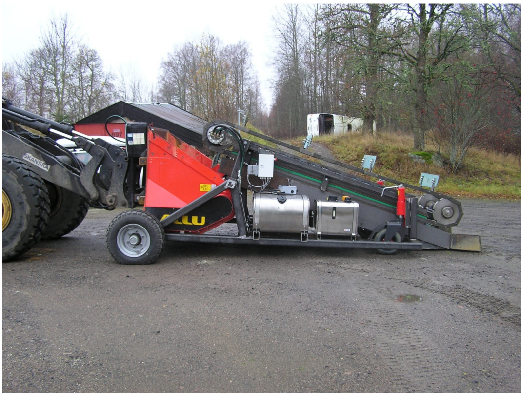
Utseende på maskinen i sidvy. Närmast hjullastaren syns Allu siktross som via en snabbkoppling dockar på upptagaren.
