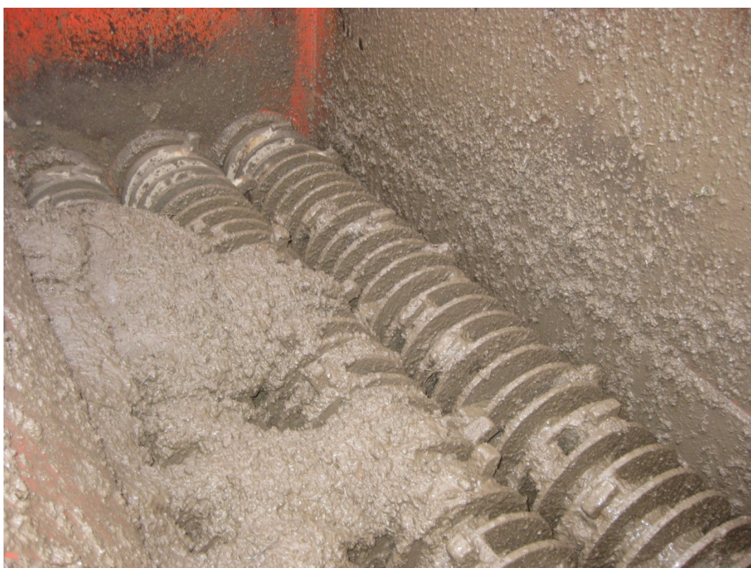
Närbild inne i Allu siktkross. Mycket blött material går igenom vid denna provkörning.
