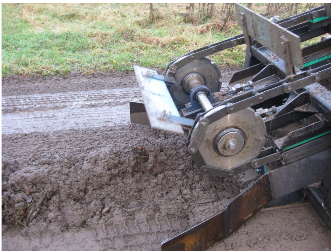
Närbild på intaget där strängen från hyveln matas in i maskinen via de kedjedrivna skovlarna. Mot vägen ligger ett hårdmetallskär som skall klara ett hårt slitage. Det blöta och tunga materialet hanteras utan svårighet av upptagaren.
